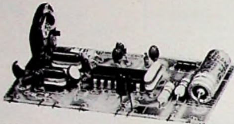
HF 330 Stereodecoder. Kanaalscheiding 40-45 dB bij 1 KHz. Phase-locked loop principe, automatische mono-stereo omschakeling. 15-55 V. f 72,50
