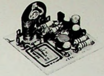
HF 65 FM zender. Voedingsspanning 4,5 - 40 Volt, frekw.ber. 60 MHz - 145 MHz, 0,3 Watt bij 40 Volt, bereik tot 10 Km. Ook te gebruiken als meetzender. BELANGRIJK!: bij gebruik als amateurzender dient PTT goedkeuring te geschieden. f 21,50
